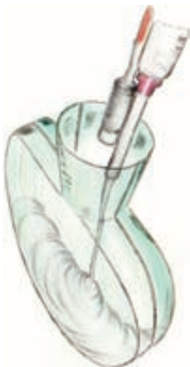
Abb. 4: Überlaufschutz für Vergussformen z.B. Kunststoffbrillengläser
